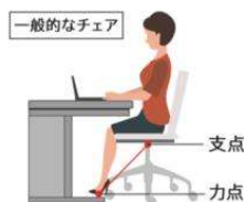
一般的なチェア 支点と力点の距離が短い
